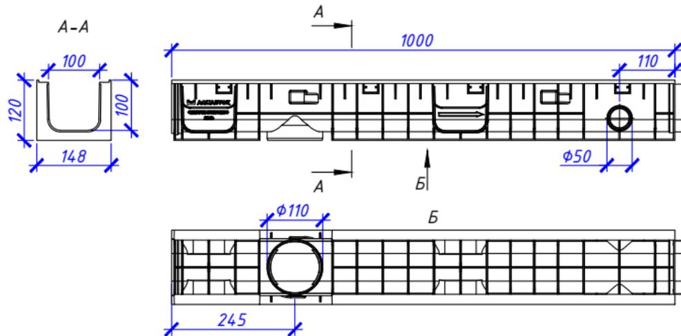
Лоток водоотводный Norma Plastik DN100 H150
